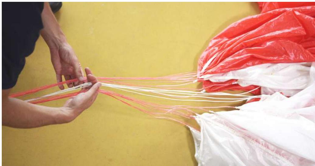
Séparer le parachute en deux (12 suspentes de chaque cote), la suspente principale basse d'Apex ainsi que les 5 hautes doivent se trouver au milieu.
