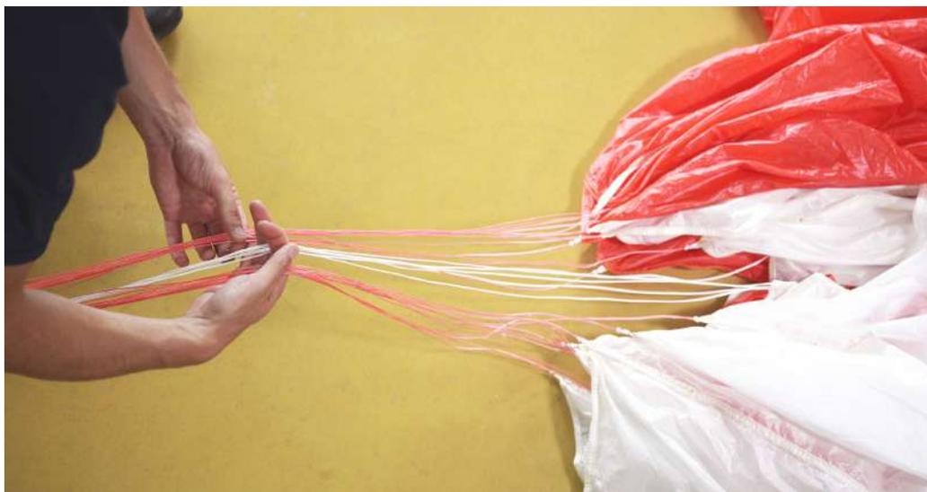
Séparer le parachute en deux (18 suspentes de chaque cote), les 2 suspentes basses principales d'Apex et les 9 hautes doivent se trouver au milieu.
